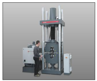
ZwickRoell Z1600H mit Hydraulik-Probenhalter
