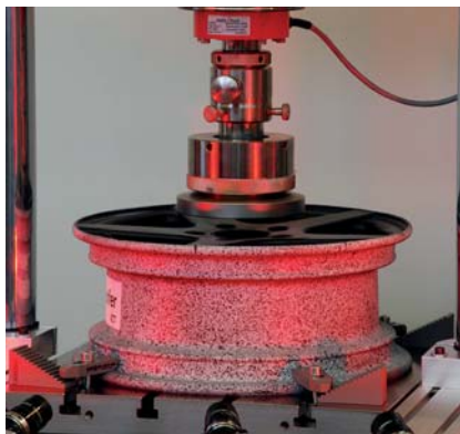
Bild 4: Messung von vollflächigen Verformungen an einer CFK-Felge
