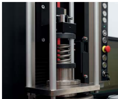
Bild 4: Prüfung von Ventilfehern
