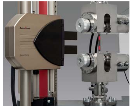
Bild 3: Probenhalter und Extensometer können jederzeit nachgerüstet werden
