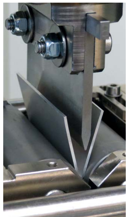
Bild 3: Plttchen-Biegeversuch nach VDA 238-100
