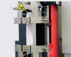
Zugversuch an textilen Flachgebilden
