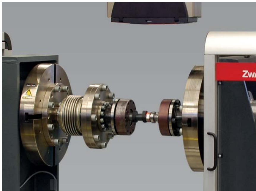
Bild 3: Torsions-Prüfung an Nockenwellen
