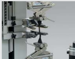
Zugprüfung an Elastomeren
