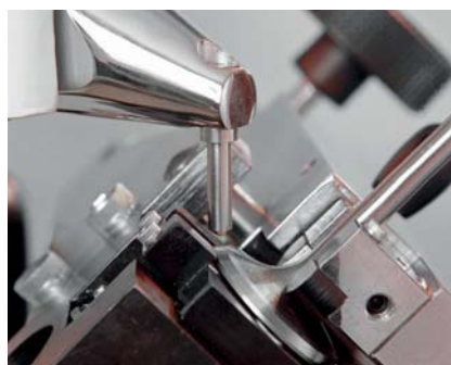
Bild 5: Härteprüfung an Ventilen
