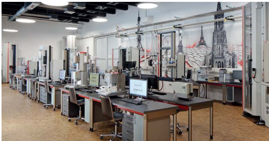
Bild 1: Statische Prüfmaschinen und -geräte im ZwickRoell Prüflabor
