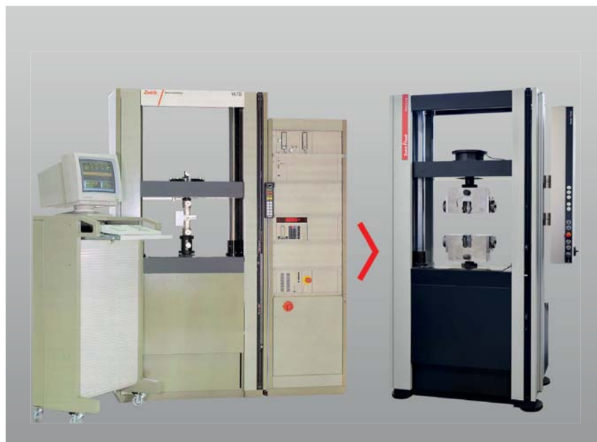
Bild 1: Modernisierung einer statischen Prüfmaschine mit testControl II
