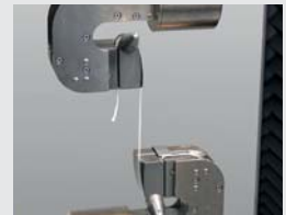
Zugversuch an Garnen
