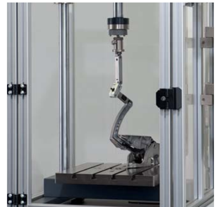
Bild 4: Ermüdungsprüfung eines Handbremshebels
