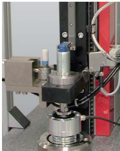
Bild 1: Prüfung von elektromagnetischen Aktuatoren
