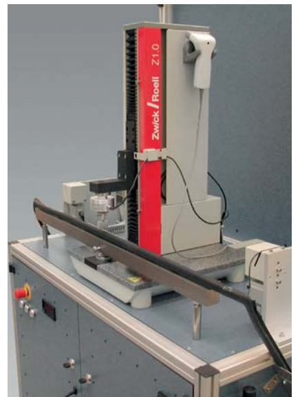
Bild 4: Prüfung von Dichtungssensoren
