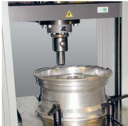
Bild 3: Prüfung von axialen Verformungen des Felgenhorns
