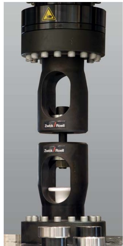
Bild 2: Ermüdungsprüfung an Schraubverbindungen mit dem Vibrophore
