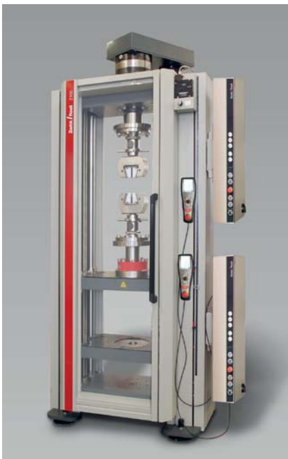
Bild 1: Tension-Torsion Prüfungen mit optischer Dehnungsmessung
