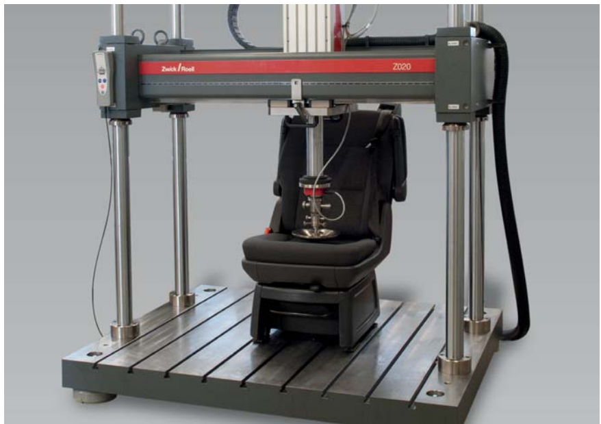
Bild 2: Flexibler Prüfstand für die Charakterisierung von Sitzen
