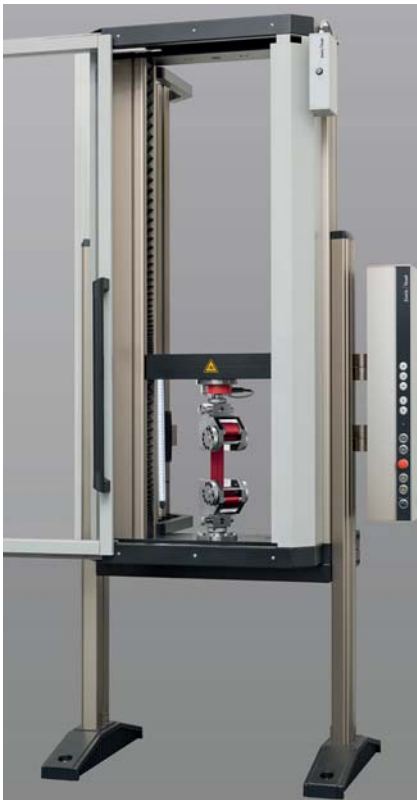
Bild 1: Zugversuch an einem Sicherheitsgurt
