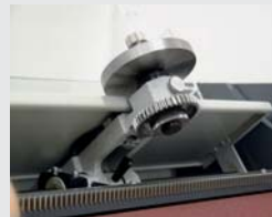
Abriebprüfung an Gummi
