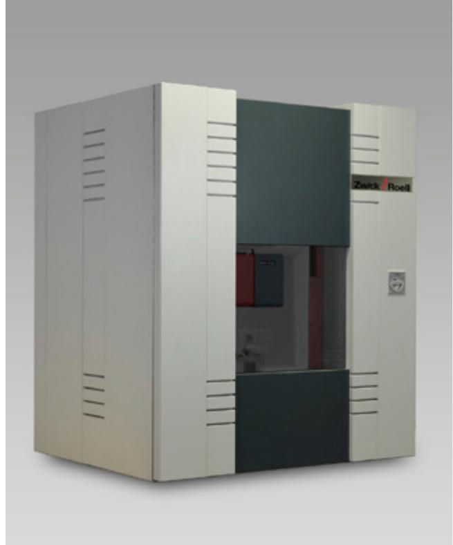
Bild 2: ZHN in Einhausung zur thermischen und akustischen Isolation
