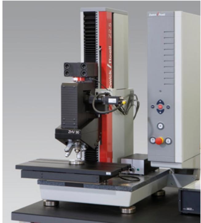
Bild 2: ZHV30/zwickiLine Härte-Prüfmaschine
