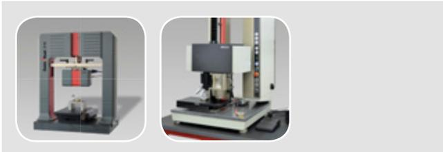
InspectorX ist die intuitive Steuer- und Auswertesoftware für Kraft-Eindringtiefe-Kurven zur Bestimmung mechanischer Parameter mit dem universellen nanomechanischen Prüfgerät ZHN. Bei geringen Eindringtiefen ist die Genauigkeit der Korrekturfunktionen für die Form der Prüfkörper sowie für den Nullpunkt (Lage der Oberfläche) und thermische Driften maßgeblich.
