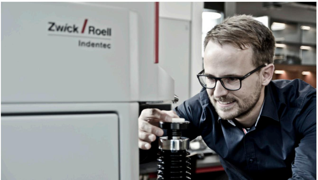
Bild 1: ZHR8150CLK bei einem Kugeleindruck-Versuch
