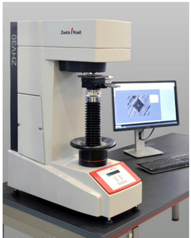
Bild 2: ZHV30 semi-automatischer Vickers Härteprüfer mit HD Software
