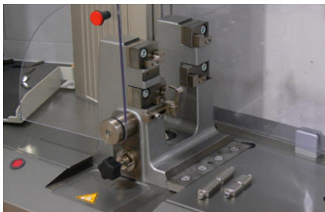
Bild 1: Charpy-Schlagbock mit lokalem Bedienerschutz, offen
