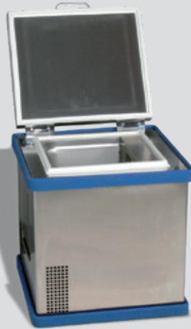
Zur Prüfung bei niedrigen Temperaturen werden die Probenkörper zunächst in einer Kühlbox temperiert. Das Magazin mit den Probenkörpern wird dann auf den Probenspender aufgesteckt, der am HIT-Pendel-schlagwerk befestigt ist. So können die Probenkörper zur Prüfung schnell und komfortabel entnommen und geprüft werden.
