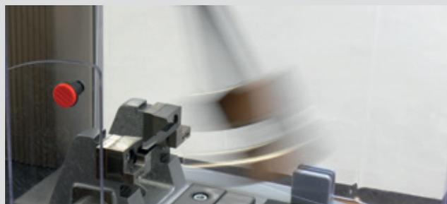
Bild 3: Einsatz des HIT25P im Schlagbiegeversuch nach Charpy
