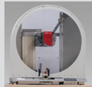
Bild 4: Elektrisch verriegelbare Schutzeinrichtung beim HIT50P
