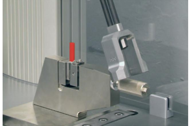
Bild 1: Prüfung mit manuellem Izod-Bock
