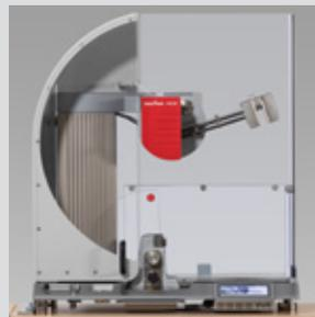
Bild 3: Schutzgehäuse beim HIT5.5P links schwenkbar und rechts fest montiert
