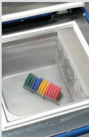
Bild 3: Temperierbox zum Kühlen von Proben/Probenmagazinen
